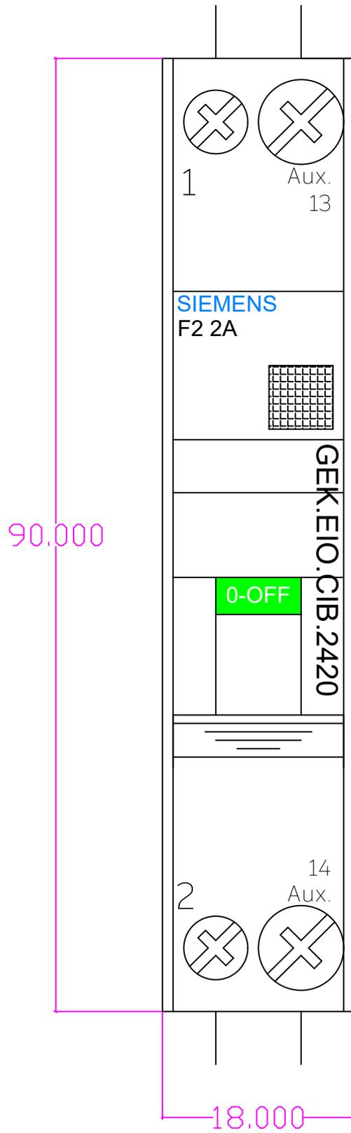
Leitungsschutzschalter 5SY 2A 24VDC REG T:70mm
