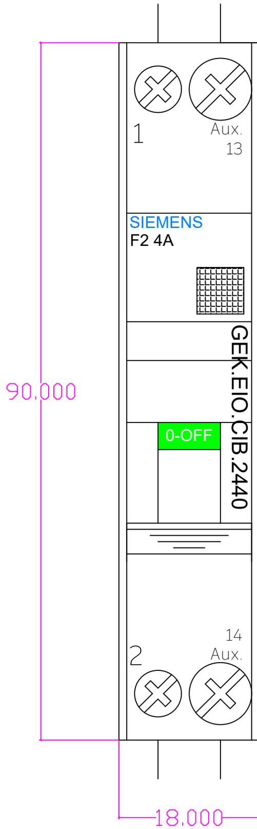
Leitungsschutzschalter 5SY 4A 24VDC REG T:70mm
