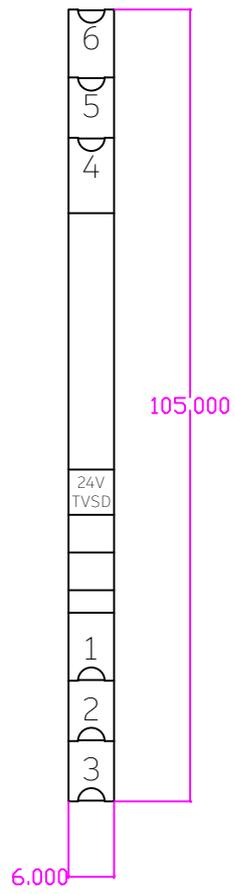
Überspannungsschutzgerät 2K/ 24 V DC T:92
