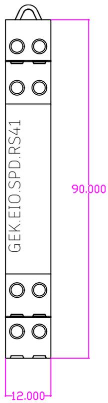
Überspannungsableiter RS485 Schnittstelle T:51mm(ohne Steckfüße)
