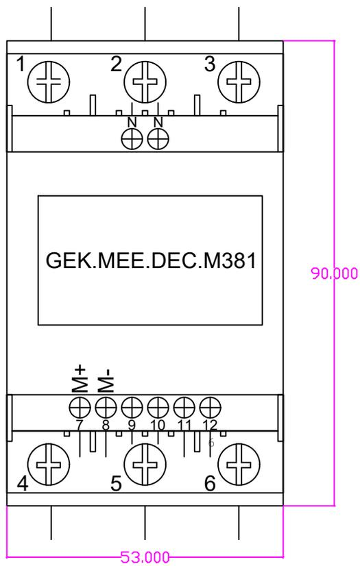
Dreiphasen Energiezähler 65A M-Bus T:63mm
