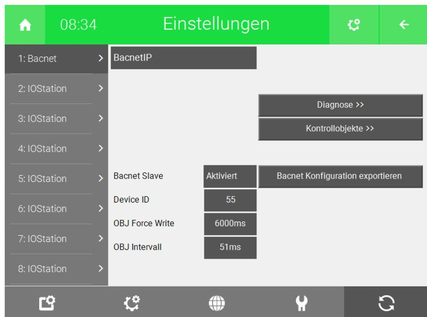
3. Schließen Sie einen USB-Speicherstick am myGEKKO an und tippen Sie auf Bacnet Konfiguration exportieren. Hiermit wird die Konfiguration mit den verfügbaren Bacnet Objekten als CSV Datei im EDE Format (bacnet\_vars.csv) abgespeichert.
