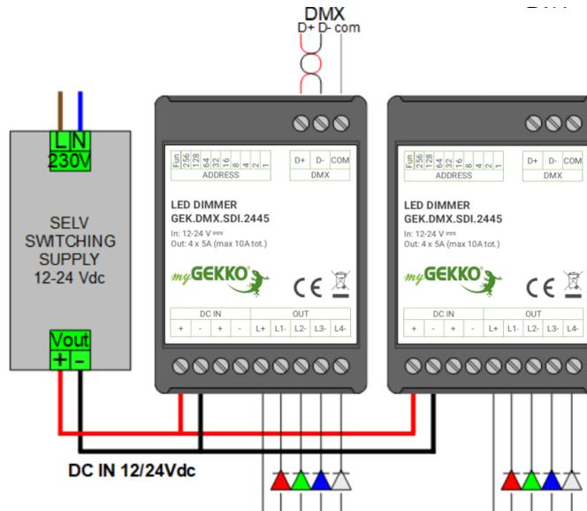
Verbinden Sie den Dimmer mit dem DMX-Bus, der Spannungsversorgung und den Leuchtmitteln (wie in der Abbildung ersichtlich).
