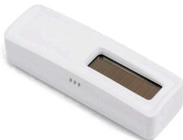
EnOcean Temperatur- und Feuchtesensoren werden an der Wand mit Klebeband oder mit Schrauben angebracht. Die Sensoren messen zyklisch im 100-Sekunden-Takt die Werte. Bei einer Temperaturänderung von 0,5°C bzw. 0,5% Luftfeuchtigkeit werden die aktuellen Daten sofort an den Gebäuderegler übermittelt, bei konstanten Werten alle 15 bis 21 Minuten.
