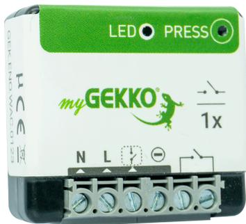
Aktor zur Steuerung eines potentialfreien Ausgangs bis zu 2,3kW. Nicht geeignet für Verbraucher mit hohem Einschaltstrom wie bspw. LED-Leuchten. Unterputzmontage in Standard-Gerätedose (Ø 68mm). Funkverbindung über EnOcean. GEK. ENO. WAC. 0123
