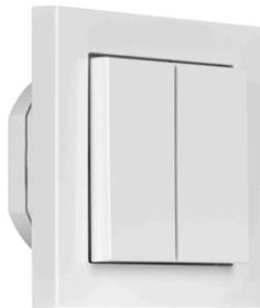
Aktor und Tastsensor zur Steuerung und Überwachung von vier frei programmierbaren Tastern und zweier potentialfreier Ausgänge bis zu jeweils 1,15kW. Kompatibel mit Standard 55x55 Wippen und Rahmen. Unterputzmontage in Standard-Gerätedose (Ø 68mm). Funkverbindung über EnOcean.
