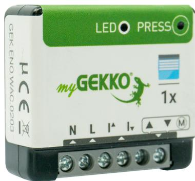
Aktor zur Steuerung einer Jalousie mit zwei gegeneinander verriegelten Ausgängen. Unterputzmontage in Standard-Gerätedose (Ø 68mm). Funkverbindung über EnOcean.
