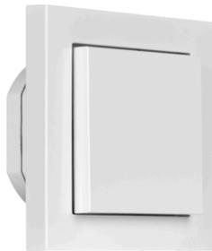
Aktor und Tastsensor zur Steuerung und Überwachung von vier frei programmierbaren Tastern und eines potentialfreien Ausgangs bis zu 2,3kW. Kompatibel mit Standard 55x55 Wippen und Rahmen. Unterputzmontage in Standard-Gerätedose (Ø 68mm). Funkverbindung über EnOcean.
