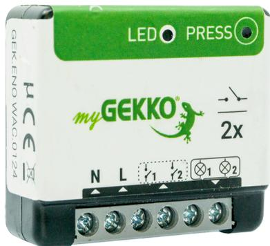
Aktor zur Steuerung zweier potentialfreier Ausgänge bis zu jeweils 1,15kW. Unterputzmontage in Standard-Gerätedose (Ø 68mm). Funkverbindung über EnOcean. GEK.ENO.WAC.0124
