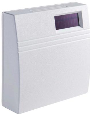
Kompatibel mit dem internationalen EnOcean Smart Home / Smart Building Protokoll überprüft dieser EnOcean Temperatur- und Feuchtigkeitssensor alle 100 Sek. die Temperatur und die Luftfeuchtigkeit Ihres Raums und gibt diese an Ihr myGEKKO OS oder Überwachungssystem zurück, sobald eine 0,5 °C Temperatur- oder +/-2% Feuchtigkeitsschwankung vorliegt. GEK.ENO.WOS.T003
