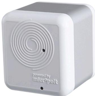
Ventilstellantrieb zur Regulierung von Heizkörpern. Batterieelos, versorgt durch Thermogenerator im Inneren. Funkverbindung über LoRa. Montage auf Ventilanschluss M30x1,5. GEK.LOR.WAC.0001
