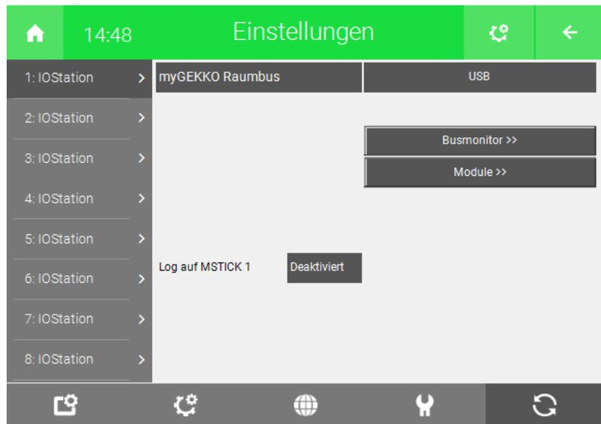
4. Die Module werden automatisch innerhalb 2 Minuten mit der jeweiligen physikalischen Adresse (ID) erkannt. Sofern ein Modul nicht gelistet ist, können Sie das Erkennen auch Beschleunigen indem Sie z.B. beim Raumtasterinterface einen Taster drücken. Über den Zeitstempel rechts in der Ansicht, sehen Sie den Status und wann zuletzt ein Telegramm des jeweiligen Moduls empfangen wurde.
