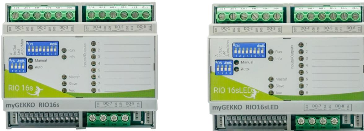
**RIO16s** Der myGEKKO RIO16s Multifunktionsaktor hat 8 digitale Eingänge und 8 digitale Leistungsabgänge (DO) mit 16 A Schaltleistung. Der Aktor eignet sich zum Steuern von Jalousien/Rolläden, sowie zum Schalten von resistiven Verbrauchern
