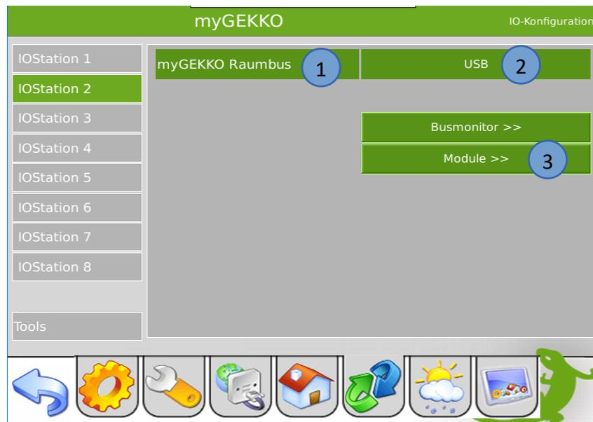
4. Die Module werden automatisch innerhalb 2 Minuten mit der jeweiligen physikalischen Adresse (ID) erkannt. Sofern ein Modul nicht gelistet ist, können Sie das Erkennen auch Beschleunigen indem Sie z.B. beim Raumbusterinterface einen Taster drücken. Über den Zeitstempel rechts in der Ansicht, sehen Sie den Status und wann zuletzt ein Telegramm des jeweiligen Moduls empfangen wurde.
