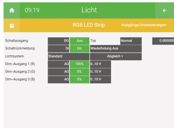
10. Bei "Schaltausgang" stellen Sie Ihren DMX Dimmer mit der entsprechenden Adresse ein. Zur Bestätigung der eingestellten Adresse wird auf den Button "Ok" gedrückt werden.
