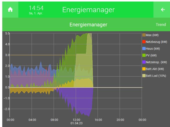
Drücken Sie einmal unten rechts am Ende des Koordinatensystems, um zum nächsten Tag zu wechseln. Drücken Sie links vom Koordinatensystem, um zum vorherigen Tag zu wechseln.
