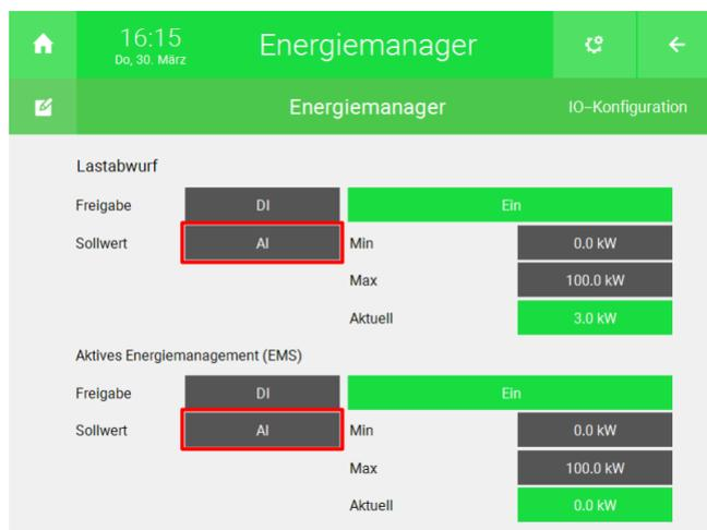
5. Die Skalierung des Sollwerts kann rechts bei "Min" und "Max" eingestellt werden.
