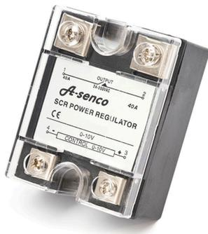
Thyristorsteller zur Leistungsregelung über Phasenanschnitt für Leistungen unter 3,6kW. Geeignet für Heizstäbe, Asynchronmotoren und andere einphasige Lasten. Montage auf wärmeableitender Oberfläche z.B passive Kühlkörper. Ansteuerung über eine Steuerspannung von 2 bis 10VDC.
