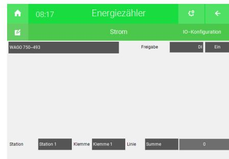
Abbildung 8: Beispiel: Verwendung Summe der Leistungen in Energiezähler
