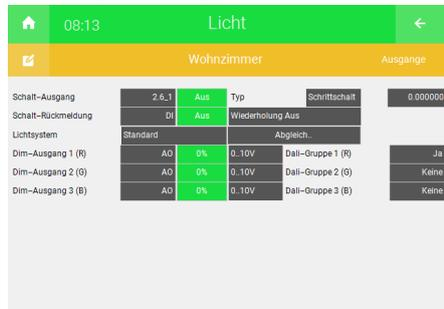
Abbildung 6: Konfiguration 3. Ebene Lichtkreis
