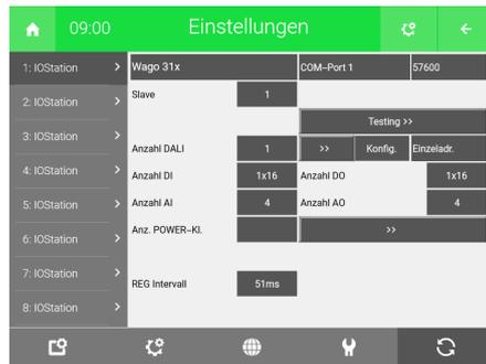
Abbildung 1: Beispielkonfiguration Wago MODBUS RTU
