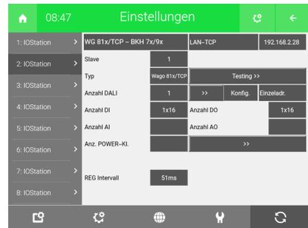
Abbildung 2: Beispielkonfiguration Wago MODBUS TCP/IP
