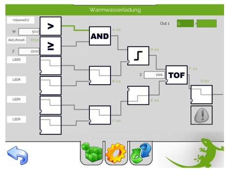
Verknüpfen Sie nun den Ausgang der Logik mit dem Starttaster der Aktion. Achten Sie darauf, dass der Merker nicht schon mal verwendet wurde.
