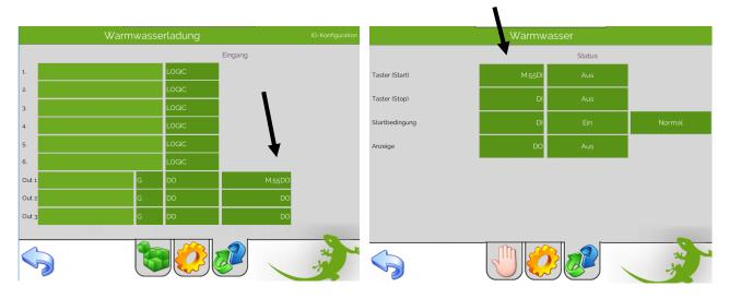
Gehen Sie in das System Energiemanager und tragen das Warmwasser in der Geräteauswahl des EMS ein. Der Energiemanager wird den Sollwert der Warmwasserladung nun automatisch beeinflussen und den Sollwert nach oben setzen, wenn Energie ins Netz eingespeist wird.
