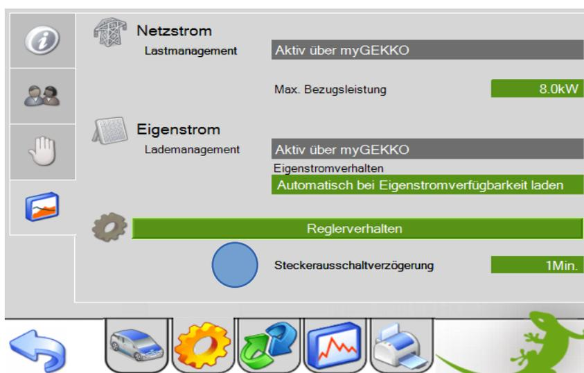
Über das Verhalten bei kurzzeitiger Trennung des Fahrzeugs vom Netz können Sie festlegen, wie lange die Steckverbindung zwischen Auto und Ladestation getrennt sein muss, damit die Ladefreigabe unterbrochen wird. D.h. wenn Sie kurz mal den Stecker ziehen, wird die Ladungsfreigabe erst nach Ablauf dieser Verzögerungszeit beendet.
