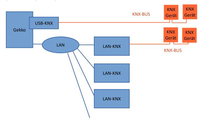
Wird mehr als eine KNX Schnittstelle an myGEKKO angebunden, so darf nur ein KNX-USB Konverter verwendet werden.
