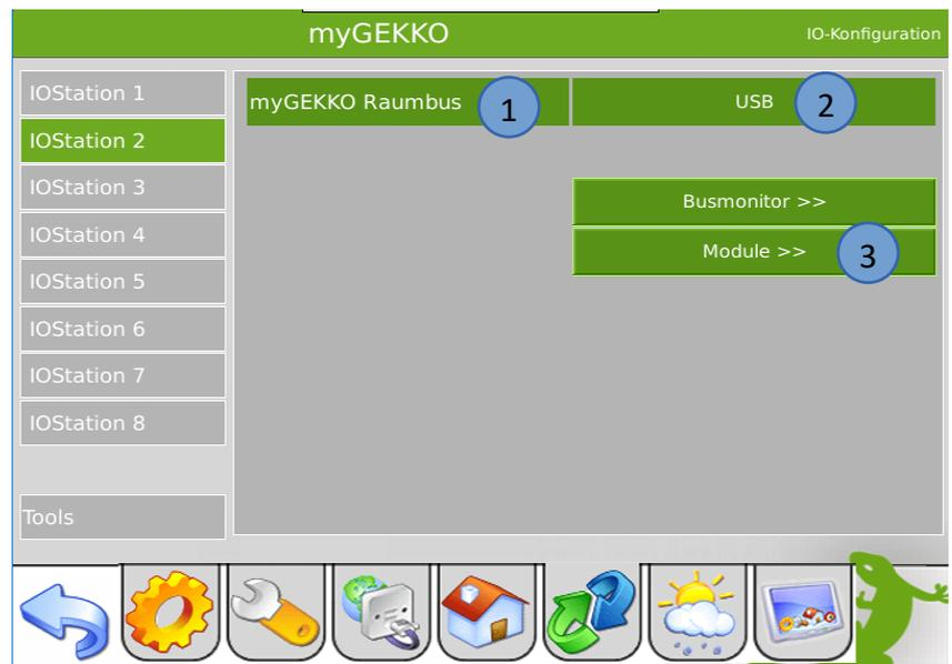
4. Die Module werden automatisch innerhalb 2 Minuten mit der jeweiligen physikalischen Adresse (ID) erkannt. Über den Zeitstempel rechts in der Ansicht, sehen Sie den Status und wann zuletzt ein Telegramm des jeweiligen Moduls empfangen wurde.
