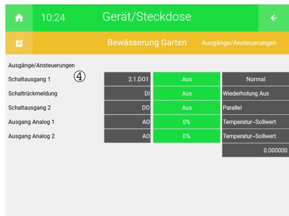
4. Tippen Sie auf den Menüpunkt "Ausgänge/Ansteuerungen", um dort die Ausgänge zu definieren. Pro Gerät können 2 Schaltausgänge (Ventile) geschaltet werden
